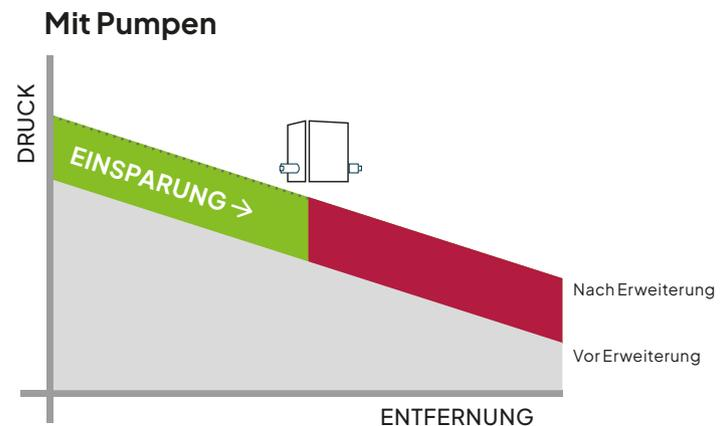
Es gibt zwei Möglichkeiten, den Druckabfall im Fernwärmenetz auszugleichen – z.B. bei einer Erweiterung des Netzes. Bei der herkömmlichen Methode wird der Druck der Hauptpumpe erhöht – und somit im gesamten Netz. Bei unserer Lösung werden kleinere, kundenspezifische Pumpstationen an strategischen Stellen des Netzes platziert, sodass der Druck nur in den erforderlichen Bereichen erhöht wird. Das ergibt Einsparungen.
